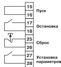
Нельзя подводить напряжение на вход органов управления. На входах имеется постоянное напряжение 24 В, и управление должно осуществляться посредством цепей, на которых потенциал отсутствует.
