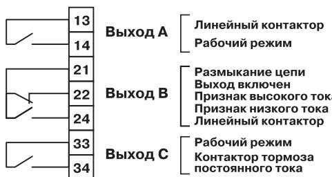
Все выходы программируемы. См. Пар. 36, 37 и 38 Назначение функции реле
