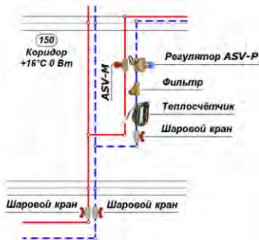
Узел присоединения квартирной приборной ветки с ASV-P
