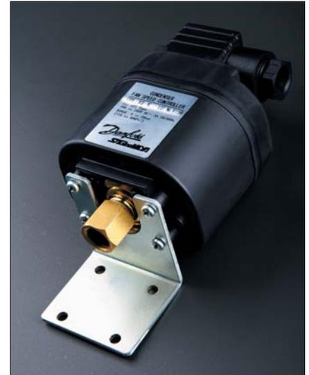
решением для сервиса существующих систем. Просто присоедините регулятор XGE к клапану Шредера, подключите его и двигатель к сети, и XGE готов к эксплуатации. Нет необходимости удалять хладагент из данного участка системы, поскольку присоединительный штуцер регулятора XGE снабжен специальным депрессором для открытия ниппеля в клапане Шредера. Регулирование установок регулятора XGE легко осуществить посредством настроечного винта, расположенного на корпусе регулятора.
