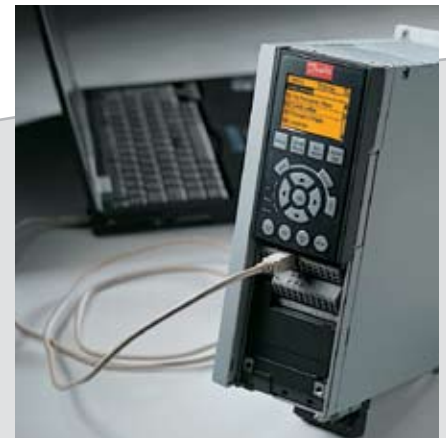
АКД может быть запущен в работу дистанционно через USB кабель или последовательную связь. Имеются специальные программные средства: Wizards, утилиты передачи данных, программные средства настройки АКД®, МСТ 10 и загрузчик языка
