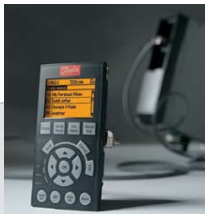
Управление АКД через панель локального управления. Она может подключаться непосредственно или через кабель
