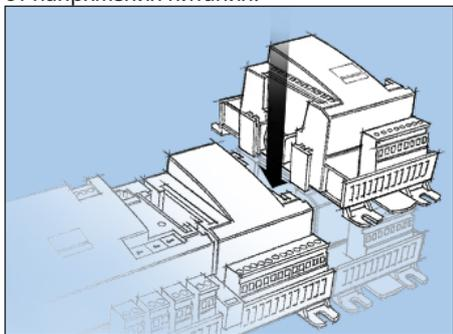
В нашем примере единственный расширительный модуль подсоединяется к базовому, как показано на рисунке:
