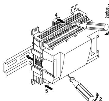
Когда обе защелки DIN-рейки находятся в позиции «открыто» модуль прикладывается к DIN-рейке и прикрепляется к ней путем нажатия на защелки. Отсоединение модуля от DIN-рейки производится при открытых при помощи отвертки защелках.
