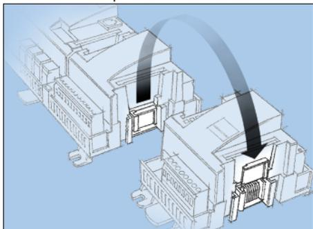
Снимите защитный колпачок с присоединительного разъема с правой стороны базового модуля. Установите колпачок на присоединительный разъем с правой стороны расширительного модуля, который будет замыкать АК-сборку.
